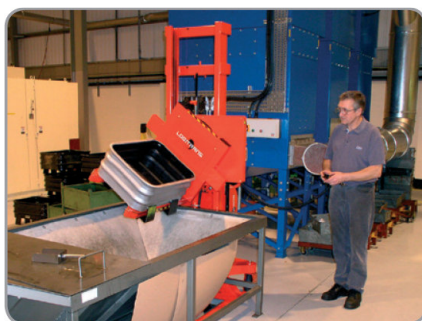
Oldalra billenthető villával vagy egyéb tartozékokkal, pl. hordóbillentő, távirányító és pozíció-felügyelet is kapható.
