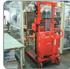
Nagyon fordulékony a rövid szerkezeti hossz, a nagy alakományozhatóság, a kerekek kényeszkormányzása és az alacsony önsúly miatt.
