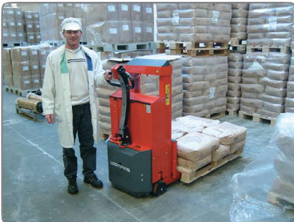
Optimális biztonság az átlátszó és ütészálló védőablaknak és a felemelt helyzetben csökkentett haladási sebességnek köszönhetően.
