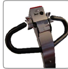
Függőleges helyzetben lévő kormányrúddal is használható Minden kezelőgomb közepén van elhelyezve.
