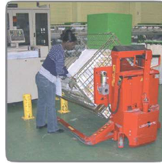
Rotatorral és/vagy olyan opcionális extra tartozékokkal rendelhető, mint a hordófordító, távirányító, szintszabályozó, beépített töltő.
